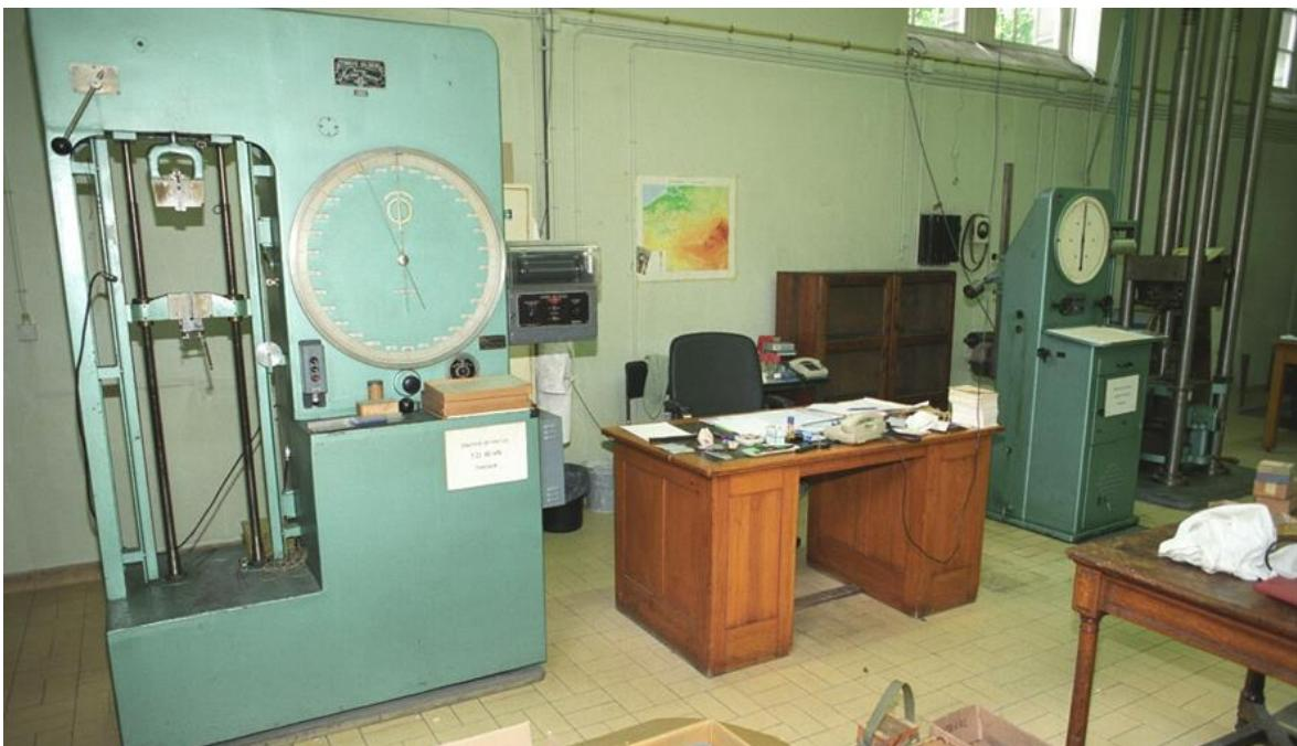
Vue des machines de traction au Laboratoire d'Essai des Matériaux au rez-de-chaussée du bloc X, le 22 mai 1996, peu de temps avant la démolition de ce bâtiment.
